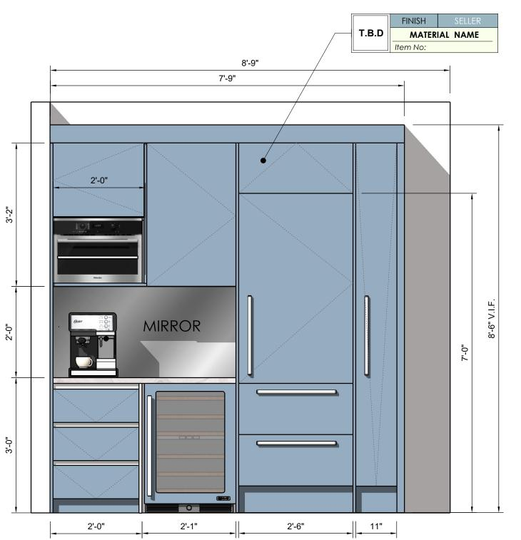
30" REFRIGERATOR / FREEZER MOLF 24" MICROWAVE **PULL OUT** Model: MDD24T/S/TH STARTED: 03/ 28/ 2024 **COMPLETED:** 04/3/2024 **REVISIONS** 04/3/2024 1 24" WINE COOLER SUB-ZERO Panel Ready. Model: DEU2450 WR **DRAWERS**
